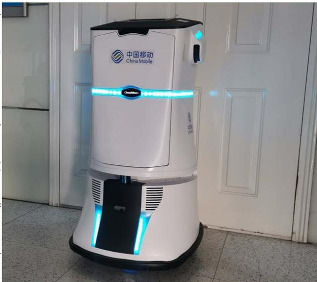
完成药物配送任务。该款机器人还配备激光雷达和碰撞传感器,能够快速感知外部环境,避免意外碰撞,实现无人化全自动运营,节约人力成本、帮助病区医护人员减少交叉感染、提升病区隔离管控水平。
